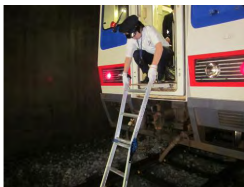
地震発生、避難はしご設置
