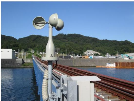
三杯式風速計
