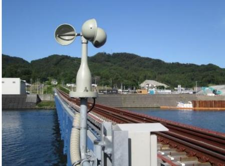
三杯式風速計
